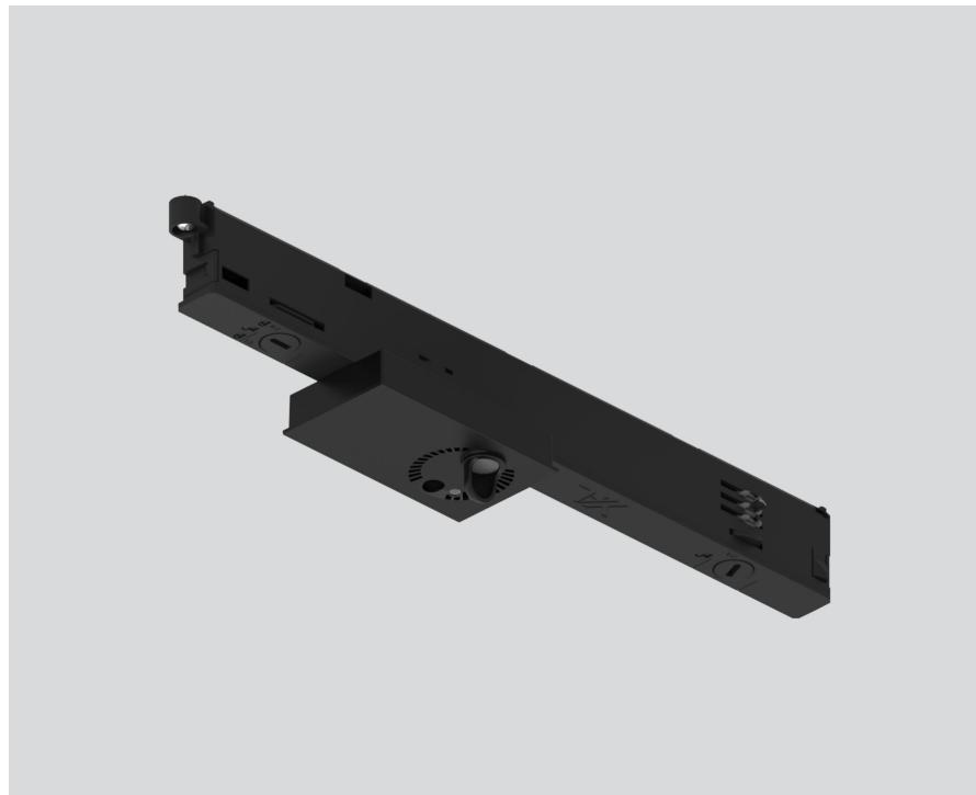
Inserto de sensor; ESSENTIAL (sensor de luminosidad y presencia); para sistemas de iluminación; superficie negro intenso; inserto puede instalarse de un modo flexible y sin herramientas; enrasado en el sistema de perfiles; grado de protección IP20; CP3; 9.5-22.5V; control con DALI-2;
