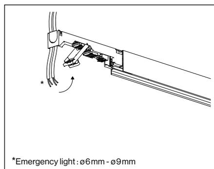
\*Emergency light :  $\varnothing 6\text{mm} - \varnothing 9\text{mm}$
