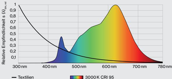
Die Grafik zeigt, dass in diesem LED-Spektrum nur wenige schädliche blaue Wellenlängen vorhanden sind. Farbtemperatur  $\leq 3000\text{ K}$  und CRI  $\geq 95$  (wie bspw. bei SASSO 60/100) ist für empfindliche Oberflächen empfehlenswert.
