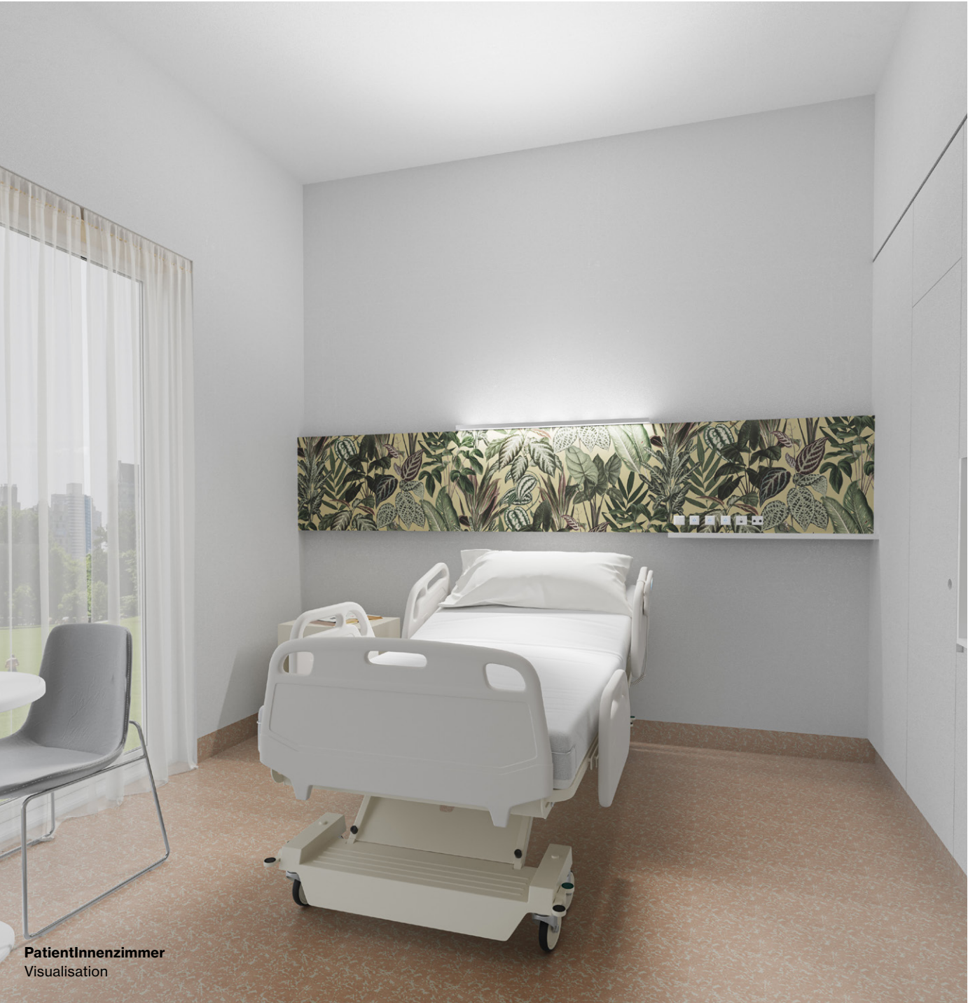
Oben: Versorgungskanal mit Cover Small Direkt-Indirekt Modul mit 2 Lichtein- sätzen
