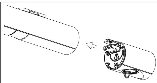
**DE** Die Demontage erfolgt sinngemäß in umgekehrter Reihenfolge der Montage.
