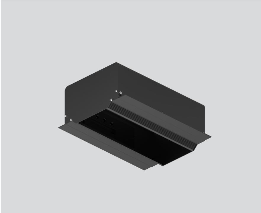
Einbaugehäuse aus Stahlblech mit rechteckigem Ausschnitt; mit umlaufendem Rand; geeignet für Deckenstärke von 12,5 mm; 3 verpolungssichere Plug & Play Anschlussbuchsen zur elektrischen Versorgung der Strahler; Strahler mittels Magnethalter werkzeuglos einsetz- und verschiebbar; Hot Plug-Schutz; Oberfläche Tiefschwarz pulverbeschichtet; Schutzart IP20; SK1; inkl. DALI-2 Konverter; alle Strahler gemeinsam DALI dimmbar; Betriebsgerät durch autorisierte Fachleute austauschbar;
