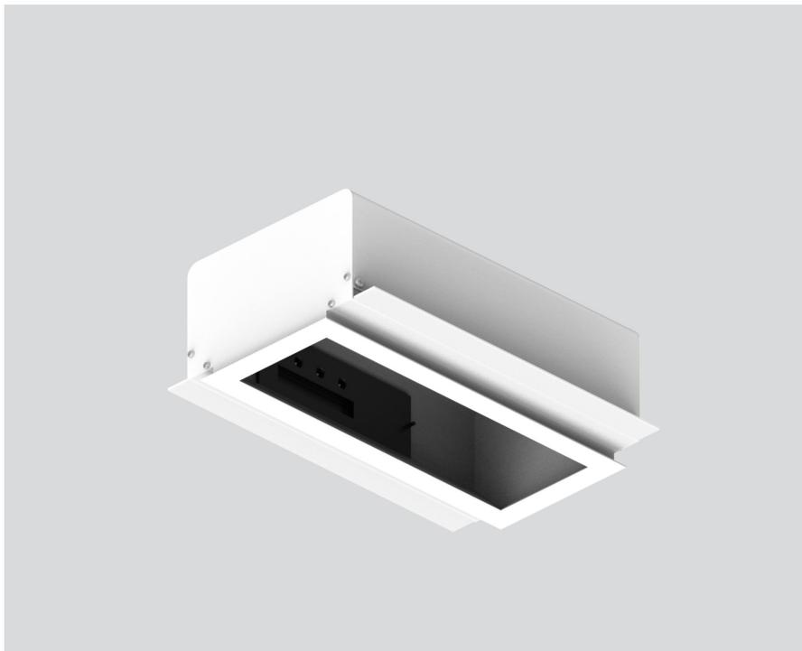
Einbaugehäuse aus Stahlblech mit rechteckigem Ausschnitt; mit umlaufendem Rand; geeignet für Deckenstärke von 12,5 mm; 6 verpolungssichere Plug & Play Anschlussbuchsen zur elektrischen Versorgung der Strahler; Strahler mittels Magnethalter werkzeuglos einsetz- und verschiebbar; Hot Plug-Schutz; Oberfläche Verkehrsweiß pulverbeschichtet; Schutzart IP20; SK1; inkl. DALI-2 Konverter; alle Strahler gemeinsam DALI dimmbar; Betriebsgerät durch autorisierte Fachleute austauschbar;
