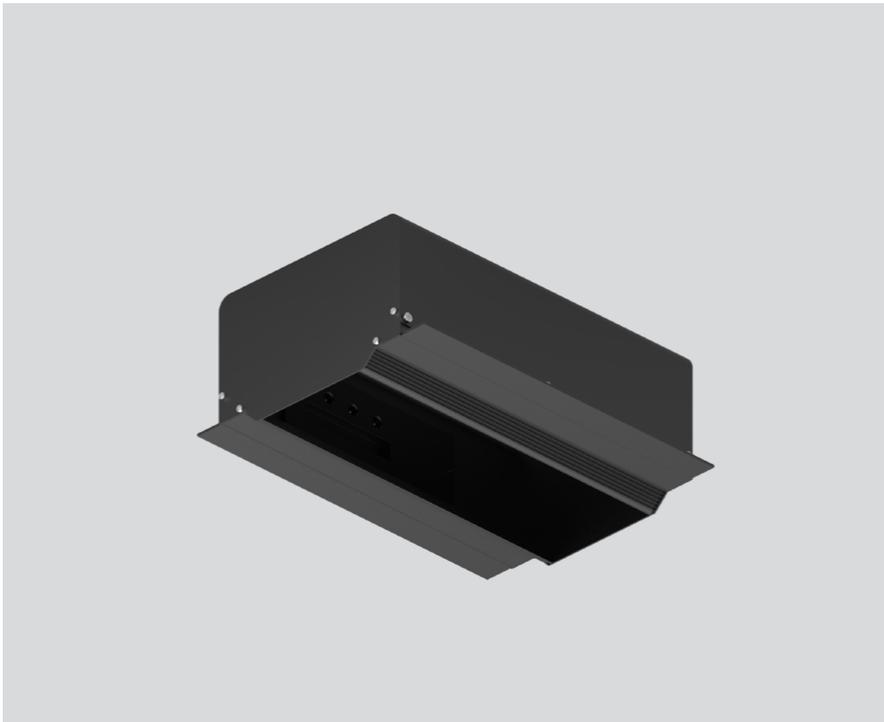
Einbaugehäuse aus Stahlblech mit rechteckigem Ausschnitt; mit umlaufendem Rand; geeignet für Deckenstärke von 12,5 mm; 6 verpolungssichere Plug & Play Anschlussbuchsen zur elektrischen Versorgung der Strahler; Strahler mittels Magnethalter werkzeuglos einsetz- und verschiebbar; Hot Plug-Schutz; Oberfläche Tiefschwarz pulverbeschichtet; Schutzart IP20; SK1; inkl. DALI-2 Konverter; alle Strahler gemeinsam DALI dimmbar; Betriebsgerät durch autorisierte Fachleute austauschbar;
